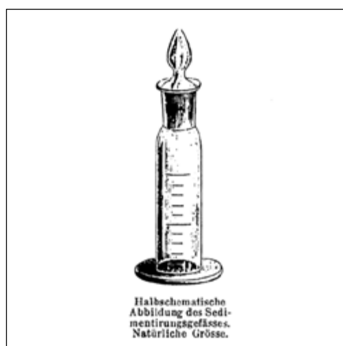
Rycina 3. Przyrząd zaprojektowany przez Edmunda F. Biernackiego do pomiaru szybkości opadania krwinek czerwonych (za: [7])
