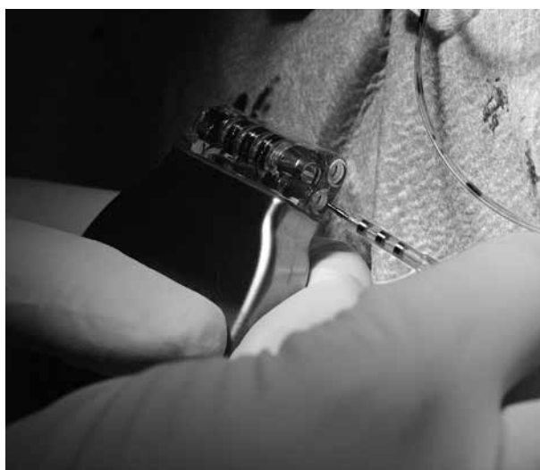
Rycina 1. Widok głowicy i elektrody defibrylującej kardiowerte-ra-defibrylatora z funkcją resynchronizacji w nowym standardzie DF-4
