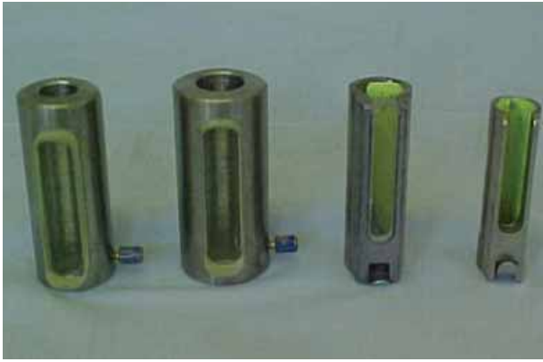
Ryc. 3. Osłony do strzykawek o różnych rozmiarach. Dwie po prawej stronie przeznaczone są dla emiterów gamma o wyższej energii, dwie po lewej dla ^{99m}\text{Tc} i radionuklidów o zbliżonej energii promieniowania gamma. Każda zawiera szklano-ołowianą wkładkę do odczytu poziomu płynu i zapięcie, by strzykawka nie ześlizgiwała się z osłony
