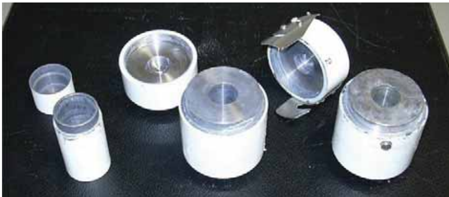
Ryc. 2. Ołowiane naczynie po lewej stronie o grubości 3 mm jest wystarczające do przechowywania ^{99m}\text{Tc} . Środkowe, dużo grubsze naczynie, jest używane do przechowywania ^{131}\text{J} . Pokrywy są zaplombowane taśmą ostrzegającą przed promieniowaniem. Grubsze ołowiane naczynia są zbyt ciężkie, by je podnieść, dlatego dodano zapięcie do naczynia zaprojektowanego dla ^{131}\text{J} , które zabezpiecza przed przypadkowym otwarciem pokrywy
