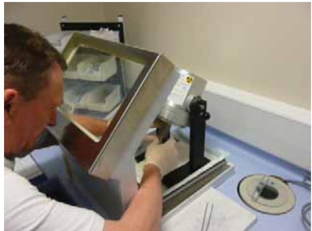
Ryc. 1. Wydobycie FDG ze szklanej fiolki wewnątrz bardzo dużego ołowianego naczynia, za grubą ołowiano/ołowiano-szklaną szybą. Należy zwrócić uwagę na rękawice zapobiegające skażeniu skóry oraz na bliskość otworu kalibratora
