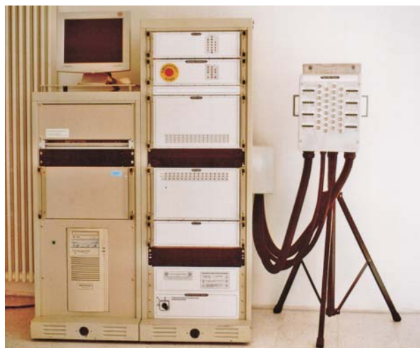
Ryc. 1. Aparatura do leczenia hipertermią; widać skrzynkę stanowiącą interfejs dla anten i zintegrowanego pomiaru temperatury
