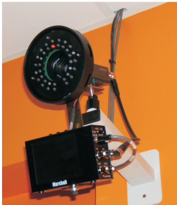
Ryc. 7. Kamera wykorzystująca promieniowanie podczerwone dla rejestracji ruchów markerów odbłaskowych (system bramkowania Variana)
