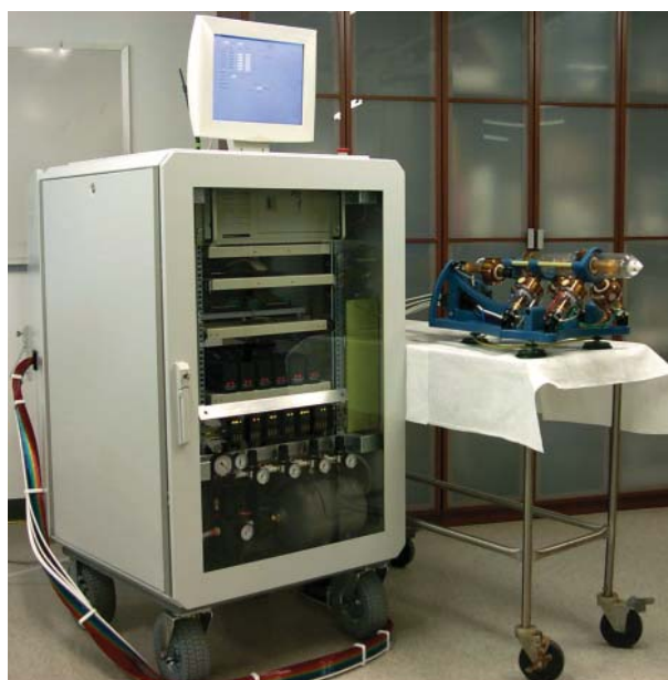
Ryc. 2. W pełni automatyczny układ do brachyterapii pod kontrolą MRI
