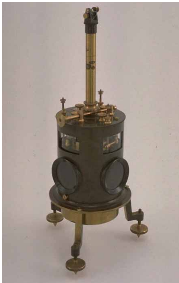
Ryc. 2. Ćwiartkowy elektrometr Thompsona-Mascarta wykorzystany przez Jacquesa i Pierre'a Curie do pomiaru piezoelektrycznego ładunku, powstałego na powierzchniach licznych hemiedrycznych kryształów w 1880 r. {Pobrane z www.uniurb.it/Phylslab/strumenti/e24/html }
