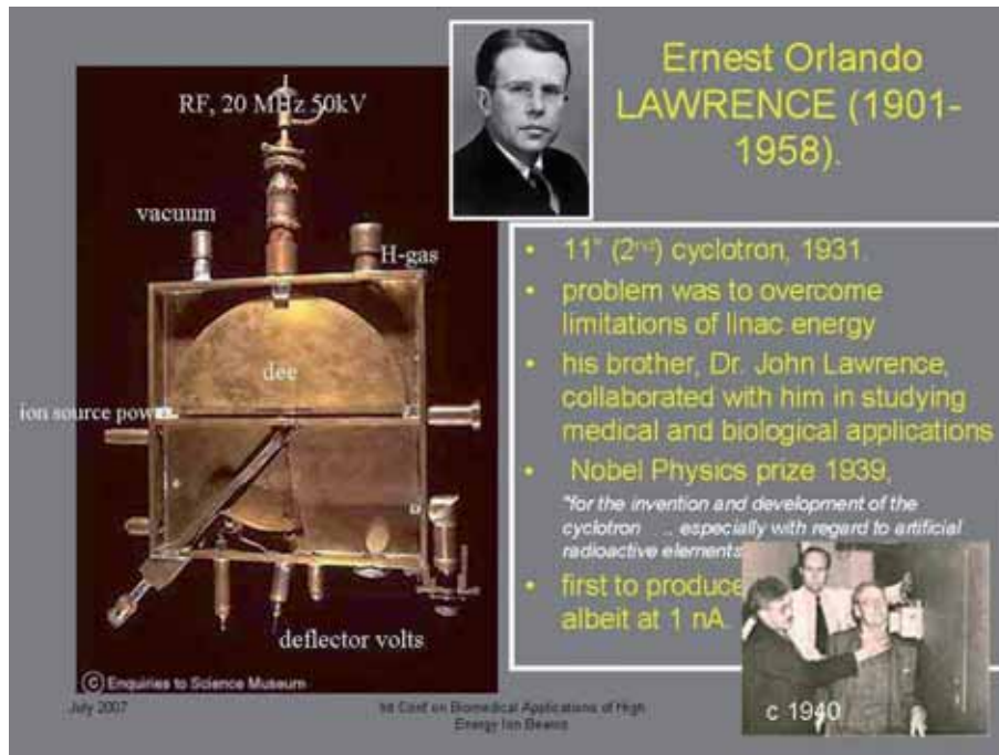
Ryc. 3. Cyklotron wybudowany na początku lat 1930. przez Ernesta Lawrence'a.
