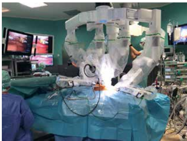
Rycina 2. Robot DaVinci Xi zadokowany w portach umieszczonych w lewej jamie opłucnowej pacjenta
