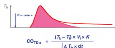
Rycina 2. Równanie Stewarda-Hamiltona do obliczania CO metodą termodylucji; T_b — temperatura krwi; T_i — temperatura iniektatu; V_i — objętość iniektatu; T_b \times dt — pole pod krzywą termodylucji; K — współczynnik korekcji zależny m.in. od wieku oraz temperatury krwi i iniektatu [9]
