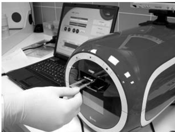
Rycina 8. Umieszczanie płytki r-Slide w komorze urządzenia
