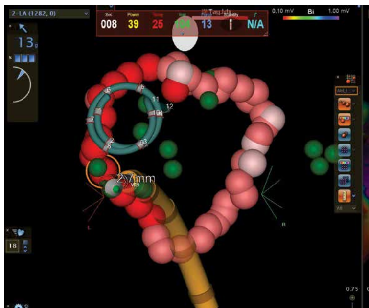
Rycina 1. „Serce w sercu na walentynki”. Projekcja RAO. Linia aplikacyjna wokół ujść prawych żył płucnych w kształcie serca. Okrężna wielopunktowa elektroda diagnostyczna LassoNav w żyłę płucną górnej prawej. Elektroda ablacyjna wprowadzona przez sterowaną koszulkę transseptalną (w kolorze pomarańczowym) „widoczną” przez system CARTO (nowinka technologiczna wprowadzona pod koniec ubiegłego roku ułatwiająca nawigację z minimalizacją lub bez fluoroskopii [6]). Małe zielone kropki — miejsca rejestracji potencjałów żylnych przed ablacją. Duże kropki — punkty ablacyjne: białe — ablation index 350–400, różowe — ablation index 400–549, czerwone ablation index > 549. By nie psuć wizerunku, oznaczenia elektrod i struktur anatomicznych przedstawiono na rycinie 2
