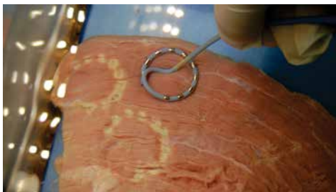
Rycina 3. Testowanie okrężnej elektrody ablacyjnej chłodzonej obiegiem zewnętrznym nMarq w łaźni wodnej na mięsie wołowym. Średnica pętli z elektrodami wynosi 25 mm. Przy dostarczaniu małej ilości energii (moc 10–15W) powstająca blizna jest nieciągła (składa się z wyseppek), co może przekładać się na nieskuteczność wykonywanej ablacji
