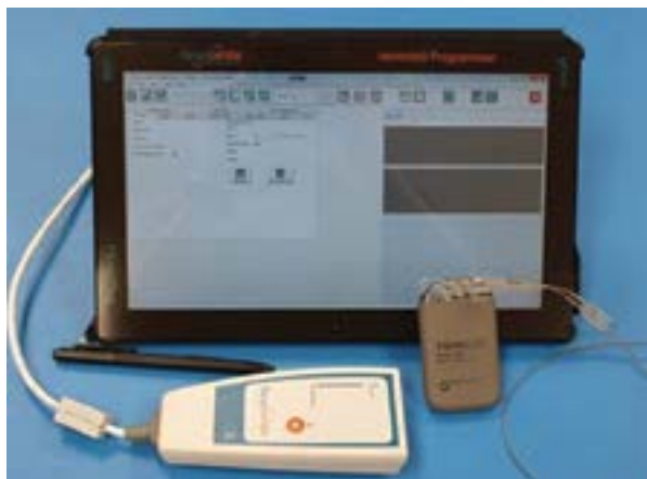
Rycina 2. System remedē złożony z implantowanego generatora impulsów, elektrody służącej do stymulacji nerwu przeponowego oraz programatora przeznaczanego do komunikacji ze stymulatorem (za zgodą Respicardia)
