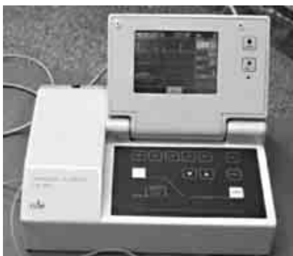
Rycina 10. Kardiostrymulator nieinwazyjny NAP-601A, umożliwiający stymulację przedsionków lub komór serca w warunkach zabiegu operacyjnego
