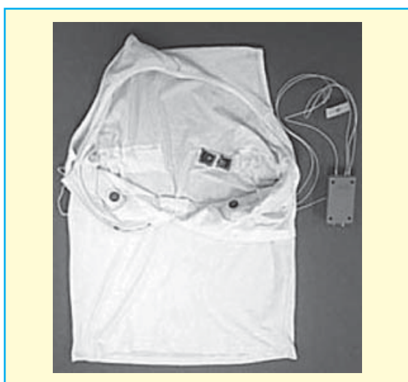
Rycina 4. Prototyp koszulki monitorującej zapis elektrokardiograficzny w czasie rzeczywistym
