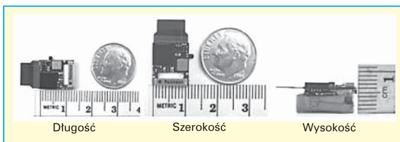
Rycina 3. Wygląd bezdotykowego czujnika sprzężonego pojemnościowo — CCNS (13 mm × 11 mm × 7 mm)
