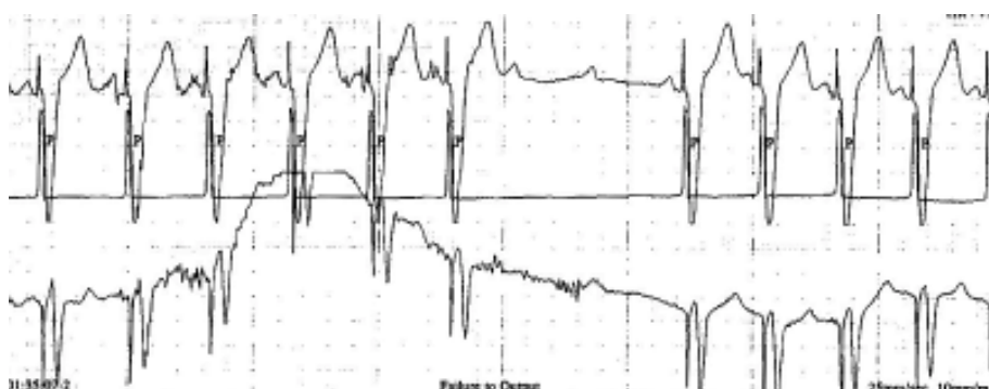
Ryc. 12. Stymulator VDD (60/min, bez histerezy, A-V — 200 ms, maks. częstość stymulacji — 140/min). Widoczny rytm zatokowy 80/min. W większości ewolucji prawidłowa stymulacja VDD. Przerwa w rytmie (2 ewolucje rytmu zatokowego bez stymulacji) spowodowana zaburzeniami sterowania (prawdopodobnie z powodu potencjałów mięśniowych).
